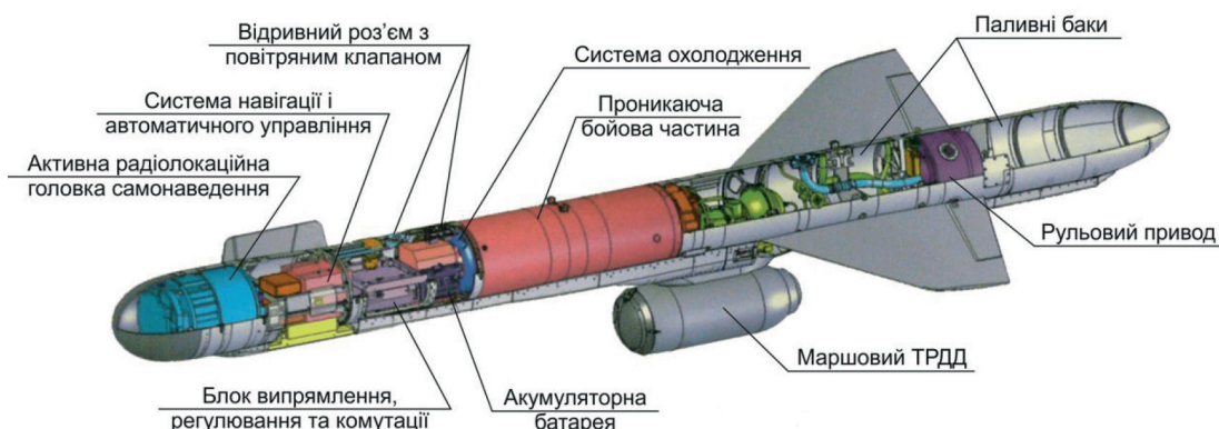
Рис. 2. Конструкція крилатої ракети X-59MK
